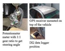
Fig. 6. Experiment setup on actual vehicle
