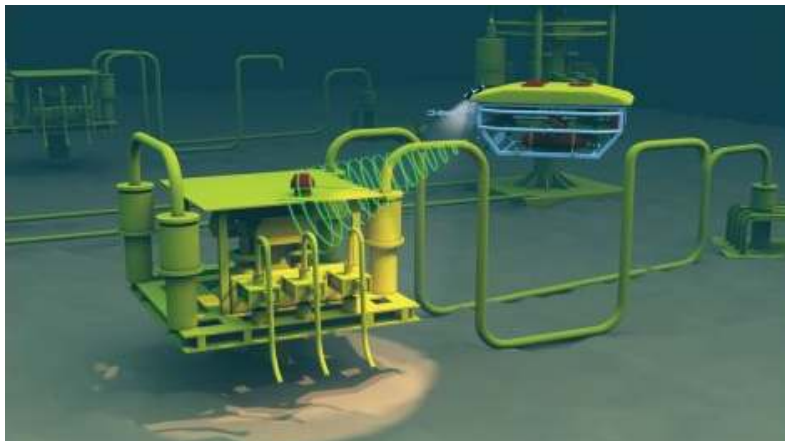
[ 수중 무선통신기술에 의한 자료전송 모습(해저 설비 → ROV) ]
