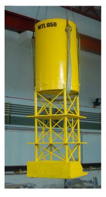
Fig. 1 Truss spar model (Scale: 1:73)
